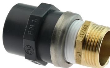
Wenn ein Übergang auf ein Metallgewinde notwendig ist und kein Übergangsfitting zur Verfügung steht, ist diese Variante die noch akzeptable, da das Kunststoffgewinde, welches mechanisch eher durch Spannungen platzen kann, zusätzlich durch den verstärkenden Metallring geschützt wird.
