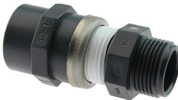
Die bessere Version: der auf das Innengewinde aufgesetzte Metallring vermindert die mechanische Spannung. Die Qualität der Verbindung erhöht sich dadurch und das Gewinde hält höheren Druck stand und ist ebenso weniger anfällig gegenüber handwerklichen Fehlern.
